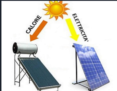
Pannello solare e fotovoltaico...
