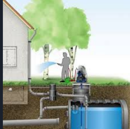
Impianto di raccolta di acqua piovana
